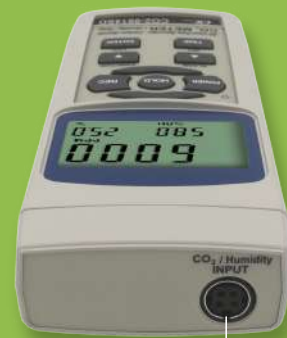
Puerto de conexión, sonda de CO2/Humedad
